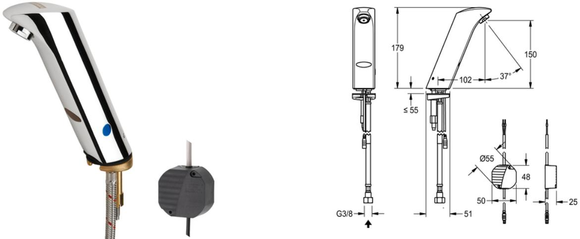
PROTRONIC-S netzabhängige, opto-elektronisch gesteuerte Waschtischarmatur DN 15 mit Luftsprudler mit integriertem Durchflussmengenregler. Zum Anschluss an vorgemischtes Warmwasser oder Kaltwasser.
