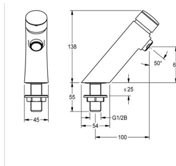
Robinet à fermeture automatique sur plan F3S DN 15 pour installations sanitaires. Cartouche à fermeture automatique, à commande hydraulique, construction sans piston, fermant automatiquement, durée d'écoulement réglable en continu. Pour le raccordement sur l'arrivée d'eau chaude prémélangée ou d'eau froide. Corps en laiton chromé poli. Mousseur à régulateur de débit intégré de 3,0 l/min.
