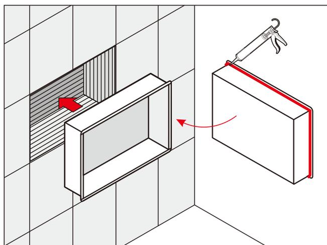
**3** Appliquez du mastic de montage sur le bord de la niche et placez-la dans le mur.
