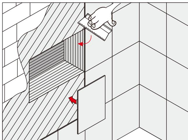
**2** Carrez le mur autour de l'espace pour la niche encastrée et couvrez la cavité avec du ciment rapide, par exemple.
