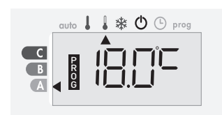
Fil pilote = Éco - 1 Confort - 1 °C
