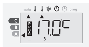
Fil pilote = Éco - 2 Confort - 2 °C
